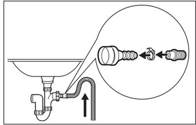
Veillez à ce que le tuyau de vidange fasse une boucle afin d'éviter que des particules passent de l'évier à l'appareil.
