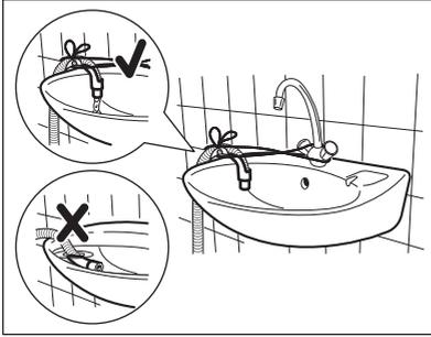
**i** Veillez à ce que le guide de tuyau en plastique ne puisse pas se déplacer lors de la vidange de l'appareil, et que l'extrémité du tuyau de vidange ne soit pas immergée dans l'eau. Il pourrait y avoir un reflux d'eau sale dans l'appareil.
