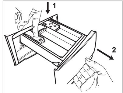
2. Retirez la partie supérieure du compartiment réservé à l'additif pour faciliter le lavage, et passez-le sous l'eau courante chaude pour éliminer toute trace d'accumulation de lessive. Après le nettoyage, remettez la partie supérieure en place.
