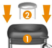
Enfoncez le couvercle fermement. Insérez le bouchon.
