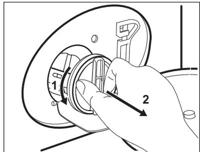
8. Si nécessaire, retirez les peluches et objets du logement du filtre.
