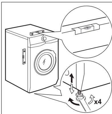
L'appareil doit être de niveau et stable.
