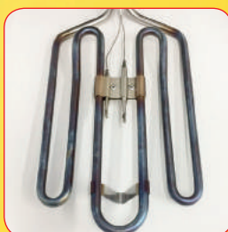
Blauwgestookt verwarmingselement Elément de chauffe bleu (surchauffé)
